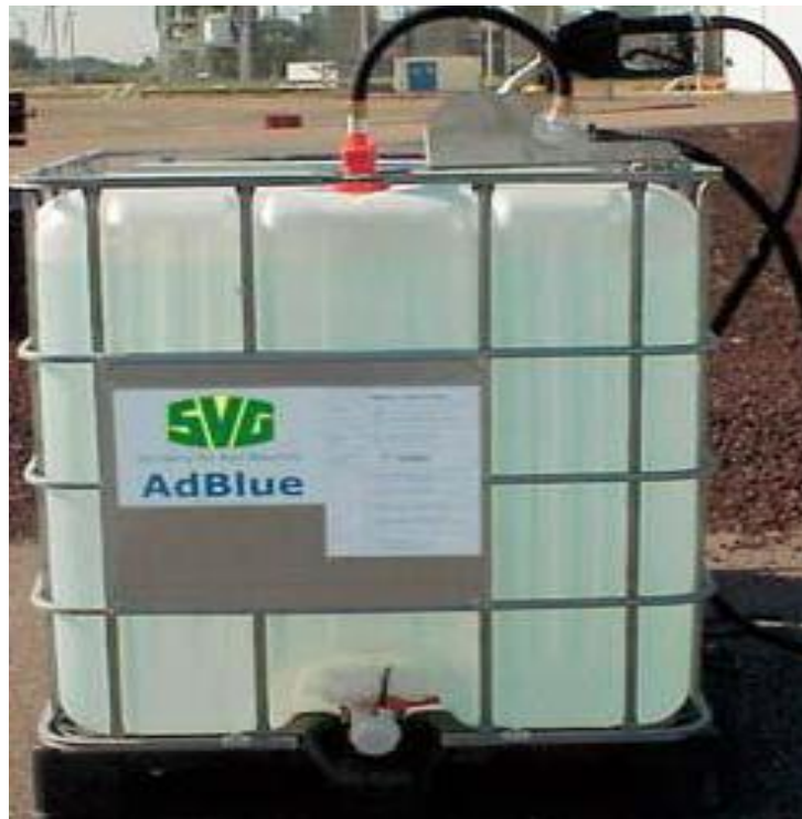
Abbildung 1: Bulk 1 IBC Pumpensystem
